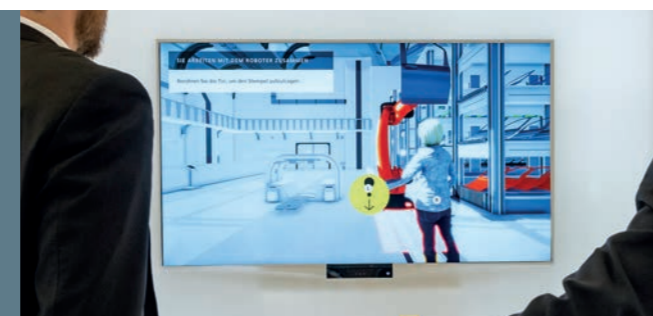
Der kollaborative Roboter visualisiert den Sicherheitsbereich und reagiert sofort, wenn es gefährlich wird.
