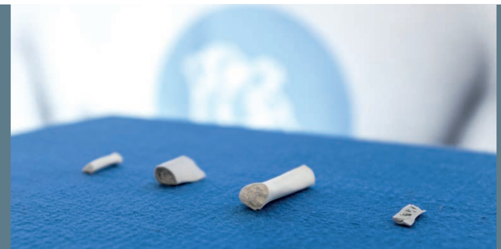
Das Fraunhofer IKTS entwickelte dazu eine Material- und Verfahrenskombination, die den menschlichen Knochenaufbau nachahmt. © Echo & Flut
